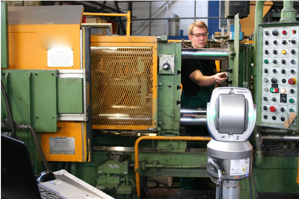
Überprüfung der Platten-Parallelität bei einer Druckgießmaschine in einem Gießereibetrieb
