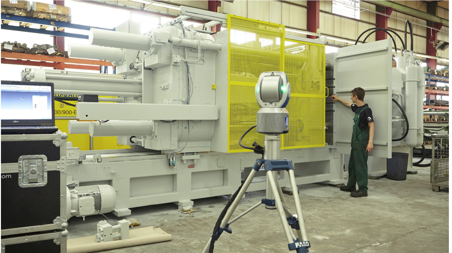
Vermessung einer generalüberholten Druckgießmaschine im DSD-Werk Lübeck.
